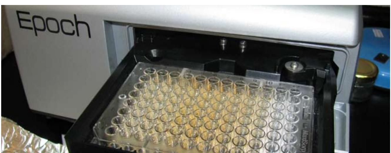
espectrofotómetro de microplacas EPOCH, lector de microplacas y que además permite realizar mediciones de varias muestras con volúmenes a nivel de microlitros (millonésima de un mililitro).
