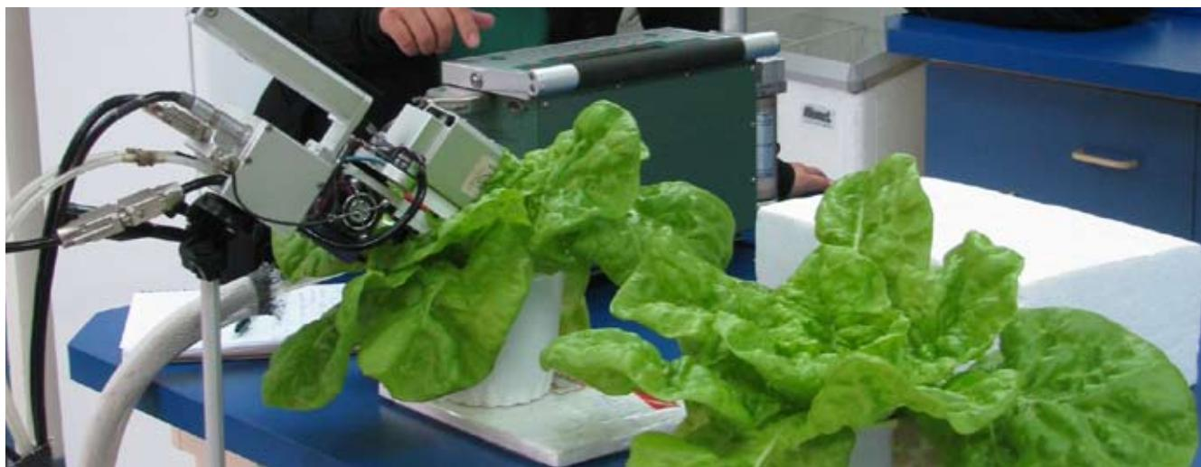
Irga (Infra Red Gas Analyzer), instrumento con el que se realizan mediciones de fotosíntesis neta y no invasiva.
