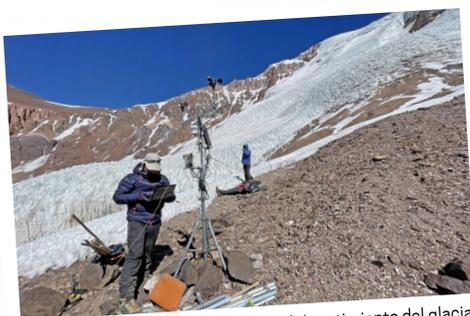
Trabajo en terreno para monitorear el derretimiento del glaciar cubierto Tapado por medio de una red de balizas de ablación.
