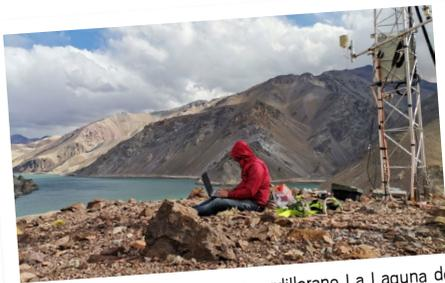
Pruebas de terreno en sector cordillerano La Laguna de nodos de medición de condiciones nivales, tecnología de telemetría desarrollada por el área meteorológica del CEAZA.
