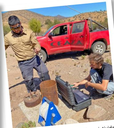
Realizando una tomografía de la resistividad eléctrica del subsuelo para caracterizar sus propiedades hidráulicas, en la quebrada El Arrayán, cuenca del Elqui.
